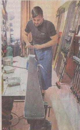
Der letzte Schliff für den Ski ist eine Wachsschicht. Wolfsberger zieht das Überschüssige ab und bürstet dann den Ski. Die Kanten sind bereits fertig.
